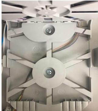
Inserire le fibre all'interno del modulo di giunzione utilizzando il groove dietro al modulo stesso.
