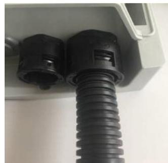
Inserire il cavetto di testa attraverso il foro per una lunghezza di 1 m. Una volta all'interno, sguainare il cavetto 1 cm circa dopo il pettine di fissaggio, eliminando eventuali filati di rinforzo (Kevlar) e fissarlo come mostrato in figura.
