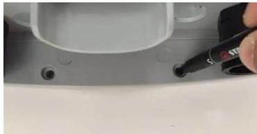
Rimuovere il PTE dalla parete e forare con punta da 6 mm in corrispondenza dei punti inferiori precedentemente segnati e fissare il PTE in posizione utilizzando le viti in dotazione.
