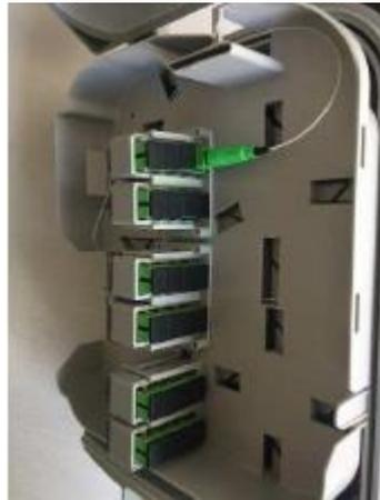
Disperdere l'extralunghezza di fibra del cavetto nella parte posteriore del modulo basculante come mostrato in figura.
