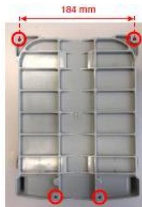
Forare la parete con punta da 6 mm e con interasse orizzontale dei fori superiori pari a 184 mm e fissare il PTE in posizione utilizzando le viti in dotazione (senza serrarle).
