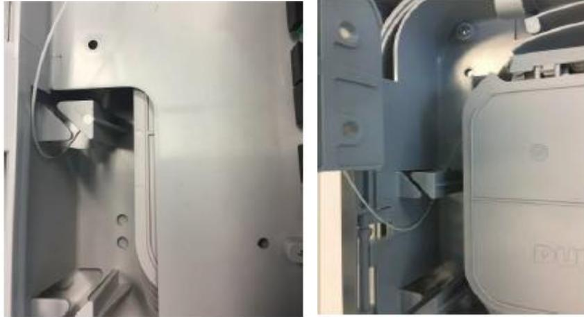
Portare la fibra all'interno del Modulo segnare con un pennarello e rimuovere il tubetto di protezione da 900µm.
