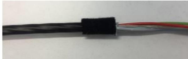
Inserire il cavo attraverso il PG13 e fissarlo all'interno del modulo bloccando l'elemento centrale nell'holder e serrandolo con la fascetta plastica nel punto indicato.
