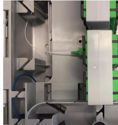
Inserire la bretella di collegamento OLO orizzontale all'interno del PTE attraverso l'imbocco dedicato alle bretelle di collegamento OLO orizzontali ed instradarla verso il modulo basculante seguendo i percorsi indicati in figura.
