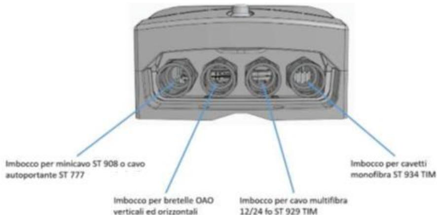
Tutti gli imbocchi circolari sono dotati di un pressaguaina mentre l'imbocco ovale è dotato di guarnizione spaccata.
