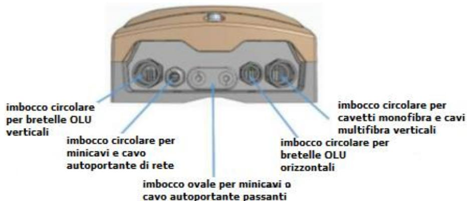
Tutti gli imbocchi circolari sono dotati di un pressaguaina mentre l'imbocco ovale è dotato di guarnizione spaccata.
