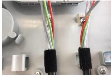
Stringere la vite a stella per il blocco dell'anima del cavo, inserire e serrare le fascette di fissaggio in corrispondenza dei punti di fissaggio.
