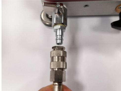
Figura 15: connessione dell'aria all' Attacco dell'aria compressa.
