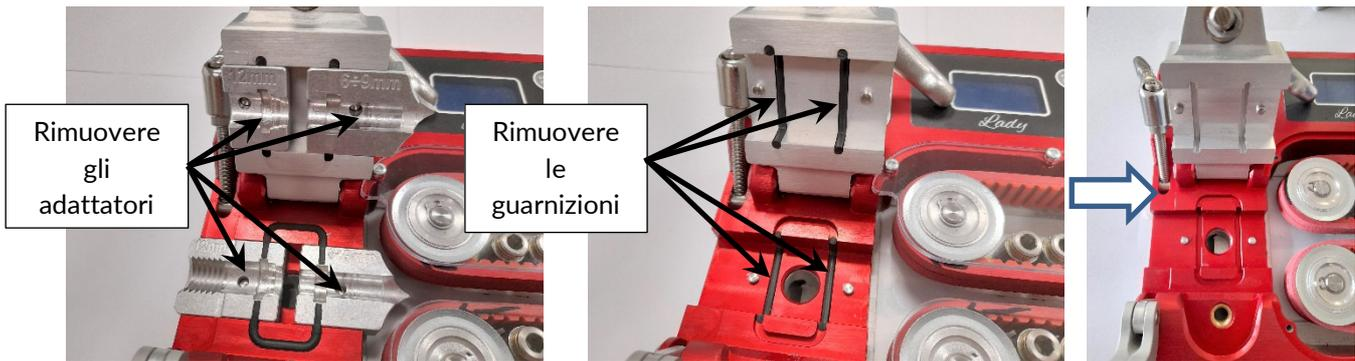
Figura 34: smontaggio adattatori per la rimozione delle guarnizioni.
