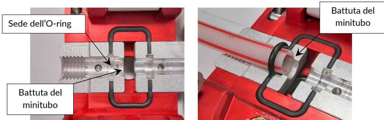
Figura 10: posizionamento dell’o-ring sulla sede.
