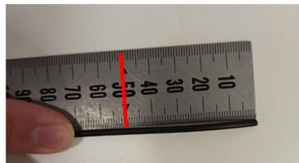
Figura 35: taglio a misura della guarnizione a metraggio.
