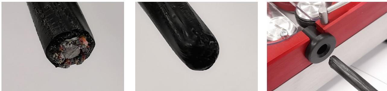
Regolare l'apertura delle cinghie per permettere il passaggio del cavo utilizzando il "Pomello di regolazione pressione delle cinghie" (6). Inserire il cavo nella "Boccola ingresso cavo" (4), aprire le ruote contametri e spingere il cavo fino a farlo passare all'interno degli "Adattatori cavo" (13.a e 13.b).
