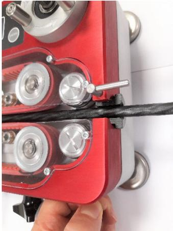
**Figura 25:** tirare la leva di regolazione ruota contametri, per permettere il posizionamento del cavo.
