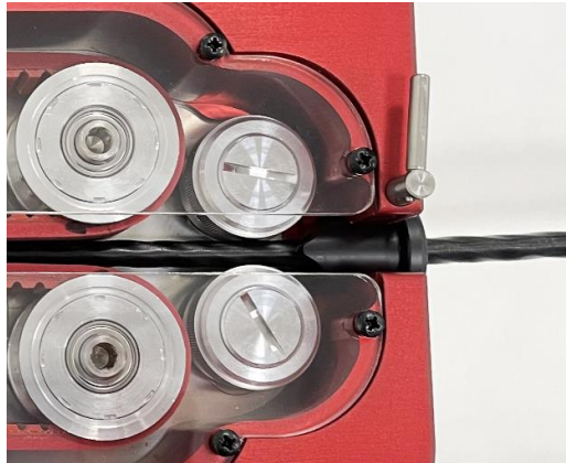
Figura 23: cavo fissato nel gruppo guida cavo.
