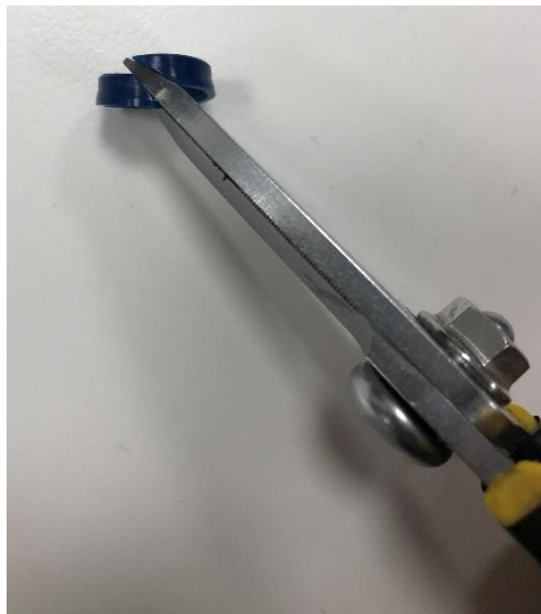
Figura 19: tagliare le guarnizioni in diagonale.
