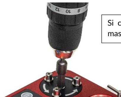
Si consiglia di inserire una bussola esagonale maschio da 10 mm nell'avvitatore elettrico
