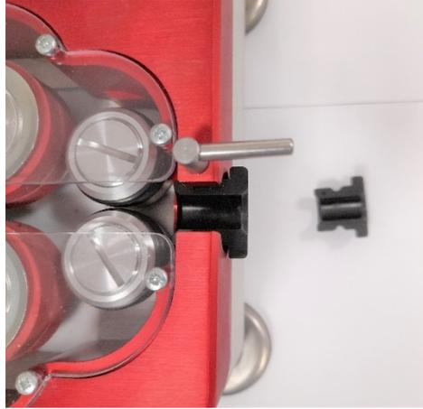
Figura 14: Aprire il kit adattatore di ingresso cavo ruotando la leva verso l'esterno
