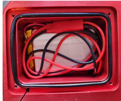
Guarnizioni del vano batteria
