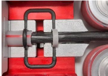
Figura 17: Posizionamento delle guarnizioni con il taglio rivolto verso il basso
