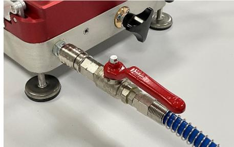
Figura 9: Collegamento del tubo dell'aria al connettore aria compressa
