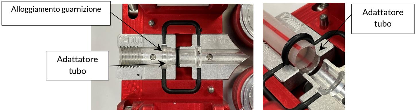
Figura 4: Corretto fissaggio del tubo
