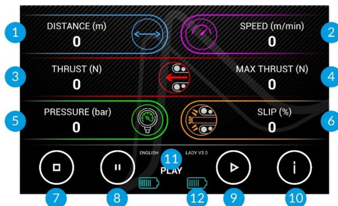
Figura 7: configurazioni del display
