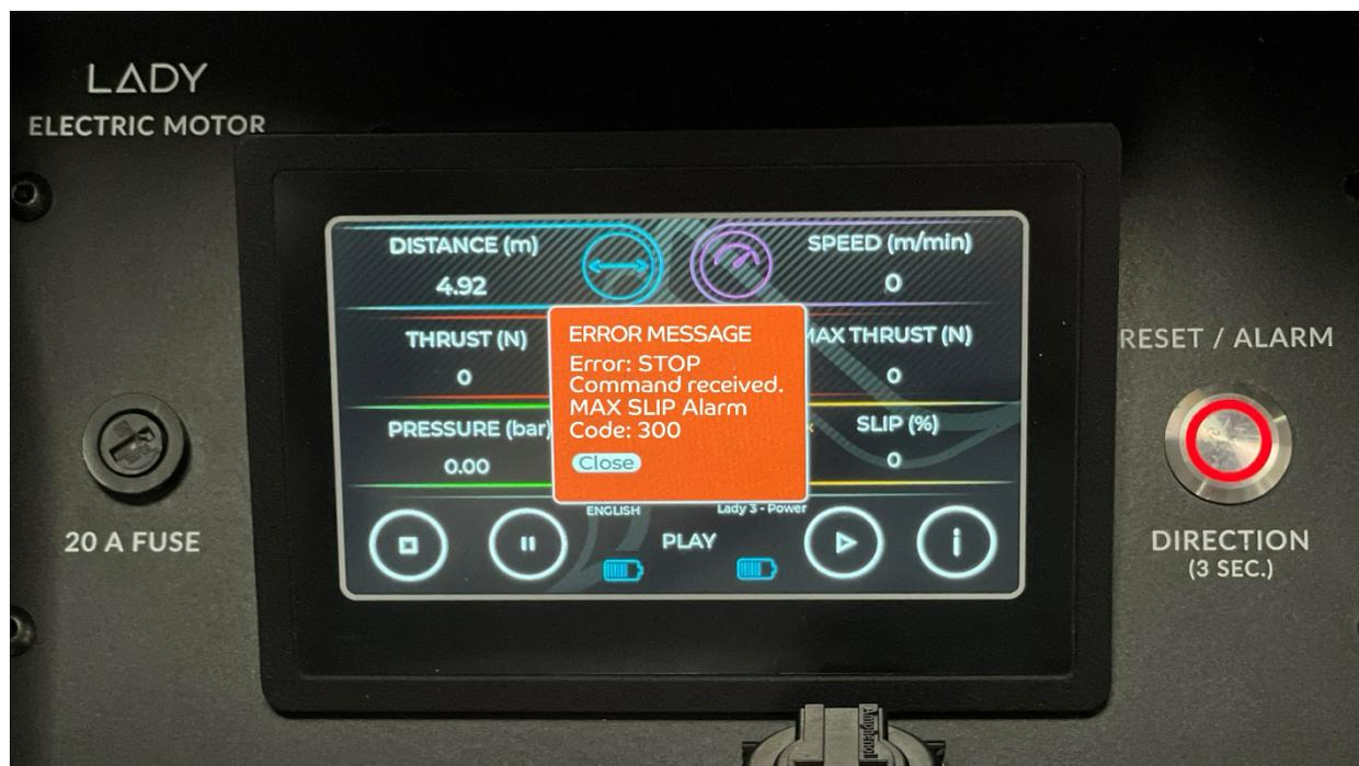
Figura 10: Errore Comando STOP ricevuto. Allarme Slittamento Massimo
