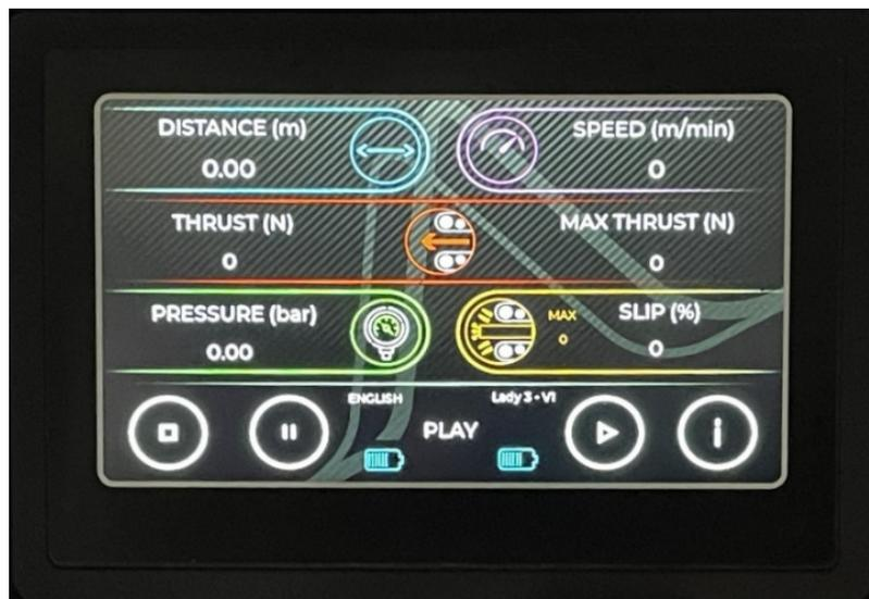
Figura 6: Display motore elettrico Lady
